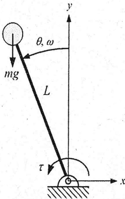
Per determinare l'angolo  $\theta$  del pendolo rispetto alla verticale è stato posizionato un sensore inerziale (dotato di giroscopio e accelerometro) ad altezza  $d$  rispetto all'asse di rotazione di caviglia.
